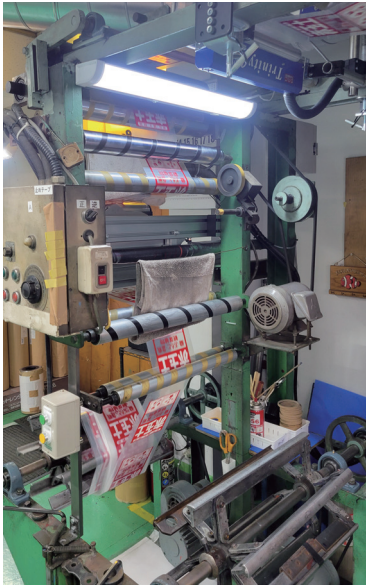
カセ巻き対応グラビア印刷機（3色機）。ダックエンジニアリング製画像検査装置付き
