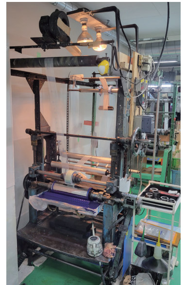
グラビア印刷機（1色機）。東社長がグラビア印刷の基本を学んだ思い入れのある装置だ
