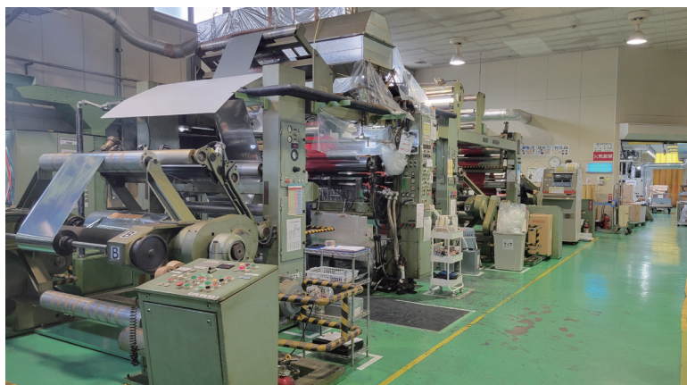
独ポリタイプ社製ノンソルベントラミネーター 対応基材幅500~1010mm
